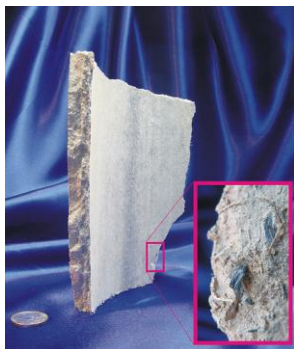
Slika A 2.31 Izgled i struktura zida azbest cementne cijevi
