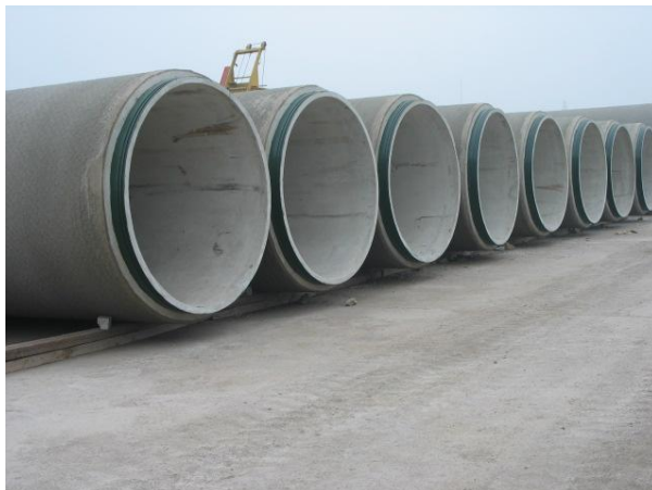
Slika A 2.33 Armiranobetonske cijevi sa unutrašnjim čeličnim cilindrom
